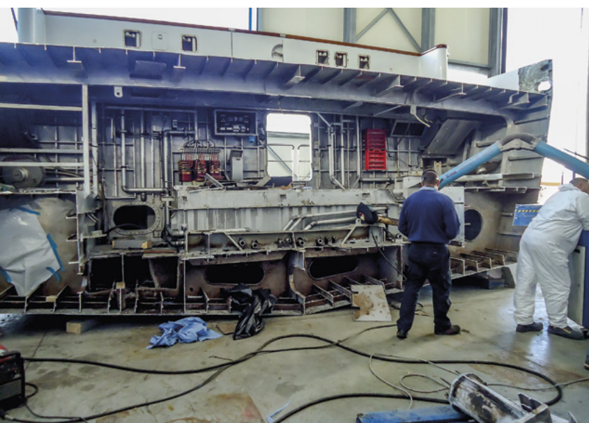
Cloud Atlas: nella foto sopra, si vede lo scafo tagliato immediatamente a valle dei braccetti portaelica in modo da non dover intervenire sulla linea d'asse. Nella foto in basso, si vede la parte finale della poppa tagliata dallo scafo originale. Nel mezzo sarà costruito il troncone di scafo che andrà a costituire l'allungamento.
