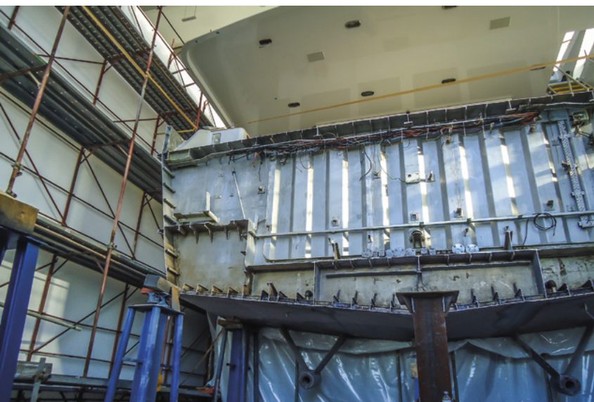
Cloud Atlas: nella foto sopra, si vede lo scafo tagliato immediatamente a valle dei braccetti portaelica in modo da non dover intervenire sulla linea d'asse. Nella foto in basso, si vede la parte finale della poppa tagliata dallo scafo originale. Nel mezzo sarà costruito il troncone di scafo che andrà a costituire l'allungamento.
